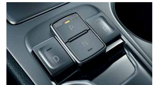
Electronic gear shift button 電子轉波按鍵
