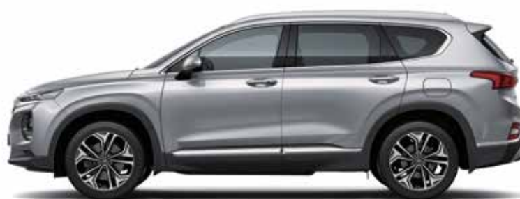
Overall Length 全長 4,770 Wheel Base 軸距 2,765
