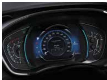
7" TFT LCD Cluster 7吋LCD儀表板
